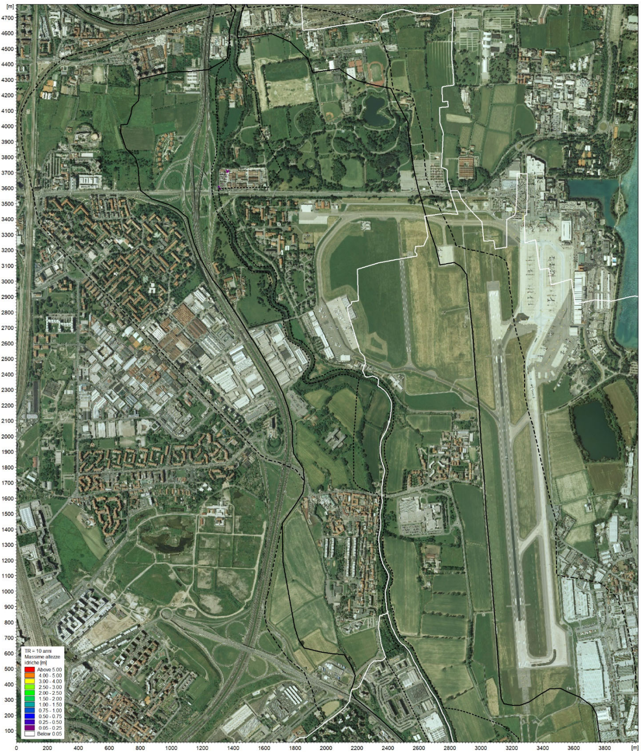
Figura 59 - Stato attuale, TR10: inviluppo delle massime altezze d'acqua rispetto al piano campagna.
