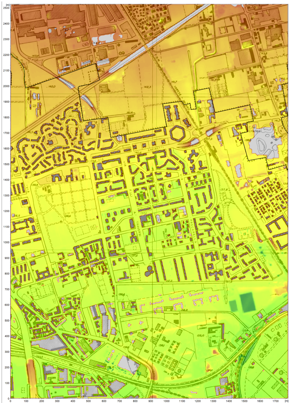
Figura 49 - Batimetria del modello 2D del torrente Garbogera a maglia 5,0x5,0 m.
